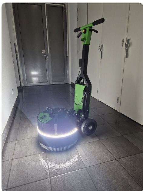
Notre deuxième prototype 48 V, une monobrosse, en train de laver du carrelage.
